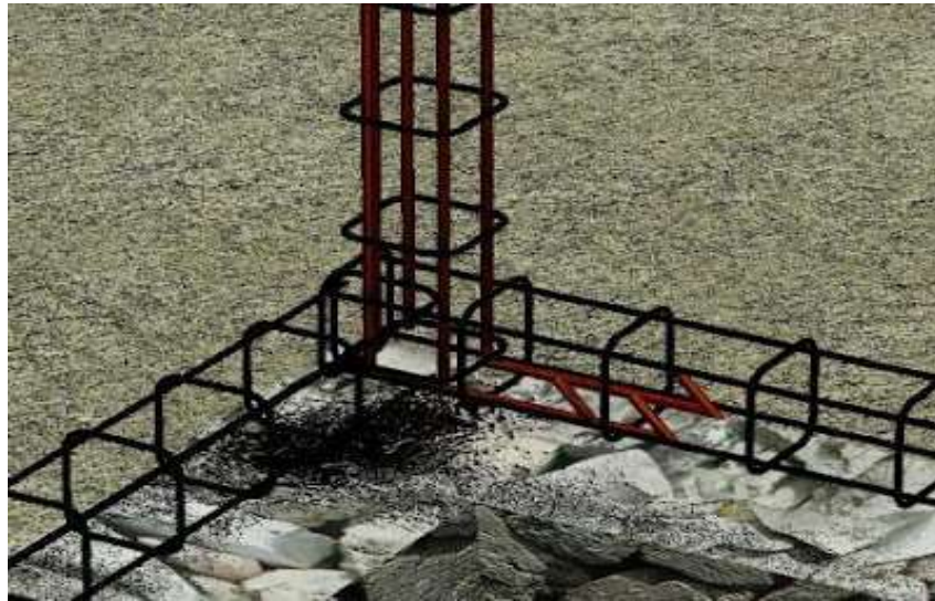
Gbr. Penulangan pada Sloof
