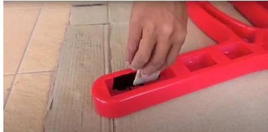
*Gambar 4. Pengaplikasian klebermann pada lubang sambungan bagian leg dan plank Bangku Taman Komposit*
